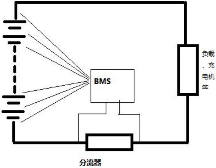
图4 分流器连接母线总负示意图
