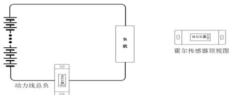
图3 霍尔传感器连接母线总负示意图
